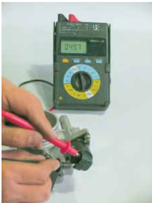
شکل ۷۲-۱- آزمایش موتور پله‌ای
