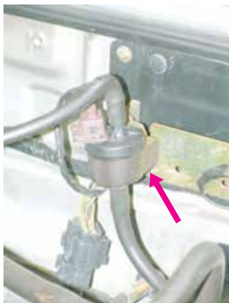
شکل ۱-۵۳- مکان نصب شیر برقی کنیستر
