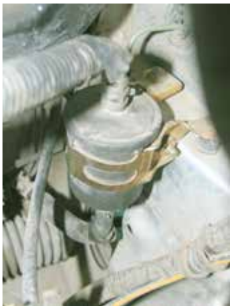
شکل ۱-۳۴- مکان نصب فیلتر سوخت
