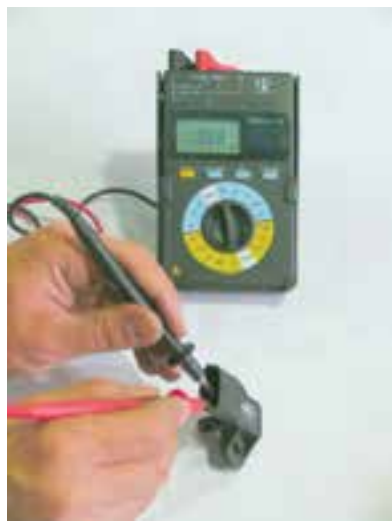
شکل ۱-۶۲- آزمایش سنسور دمای هوا
