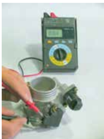
شکل ۱-۶۴- آزمایش سنسور موقعیت دریچه گاز
