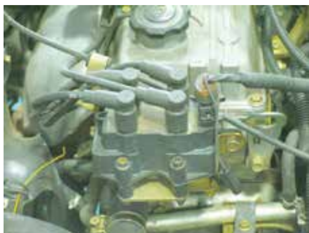
شکل ۱-۴۵-۱- مکان نصب کویل دویل
