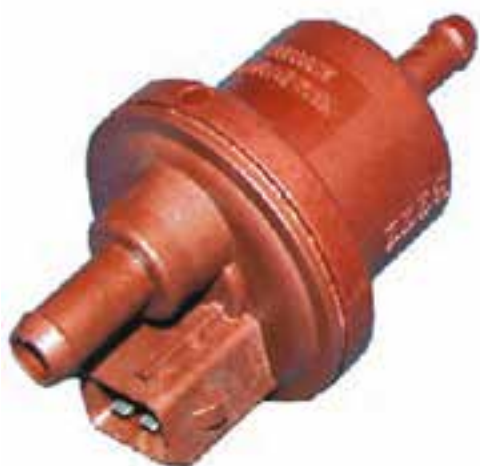
شکل ۱-۵۴- شیر برقی کنیستر
