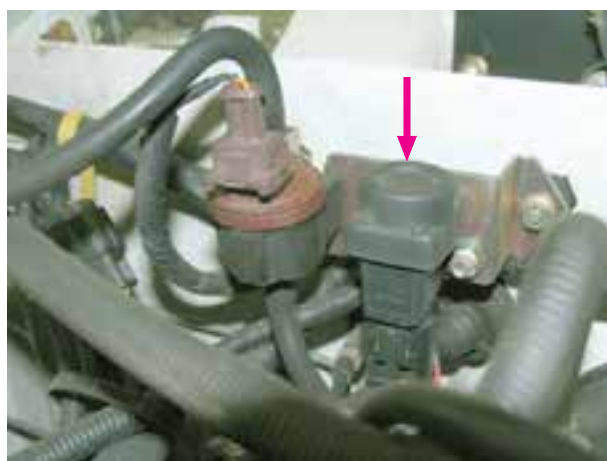
شکل ۱-۴۹- مکان نصب سوئیچ اینرسی
