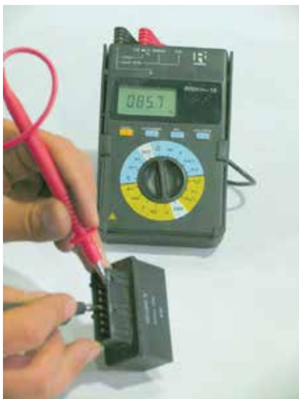
شکل ۱-۷۴- آزمایش رله دوپل
