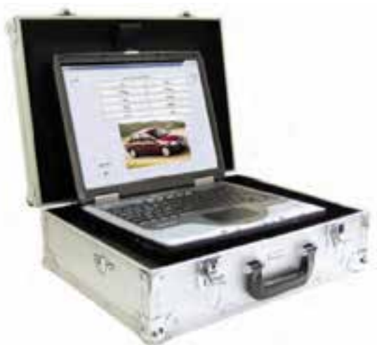
شکل ۱-۵۸- دستگاه عیب‌یاب لپ‌تاپی
