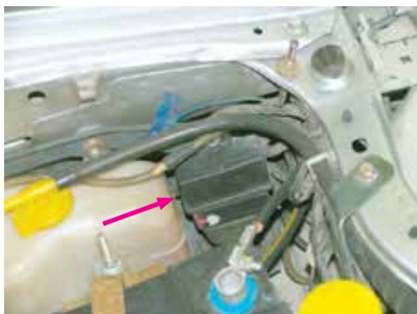
شکل ۱-۴۷- مکان نصب رله دوپل
