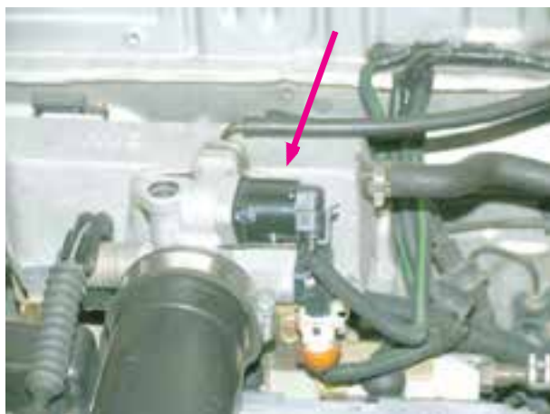
شکل ۴۳-۱- مکان نصب موتور پله‌ای
