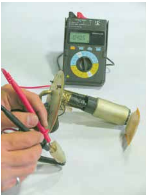
شکل ۱-۷۰- آزمایش پمپ بنزین
