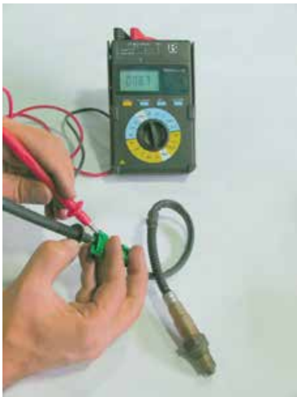
شکل ۱-۶۹- آزمایش سنسور اکسیژن
