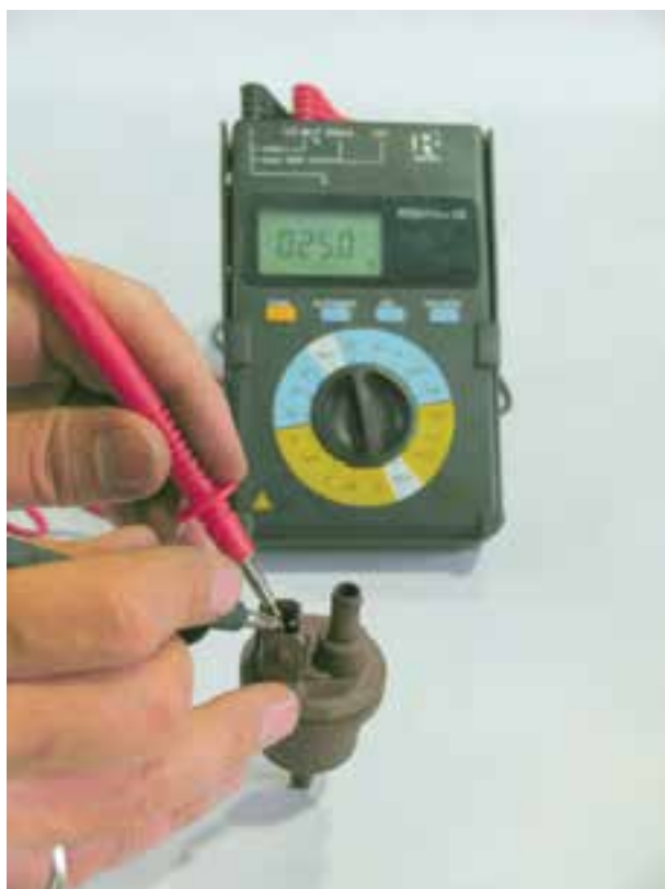
شکل ۱-۷۵- آزمایش شیر برقی کنیستر
