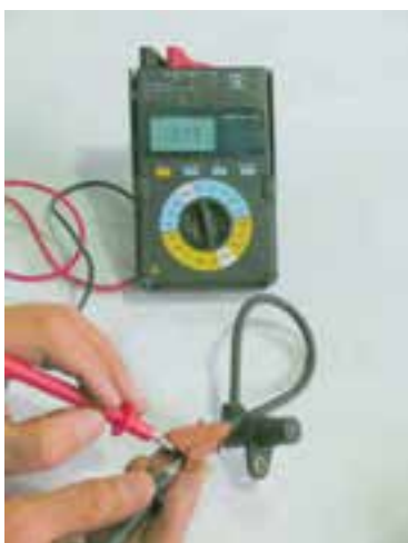
شکل ۱-۶۵- آزمایش سنسور دور موتور
