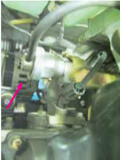
شکل ۳۸-۱- مکان نصب رگلاتور
