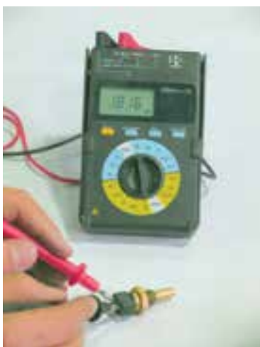
شکل ۱-۶۳- آزمایش سنسور دمای آب
