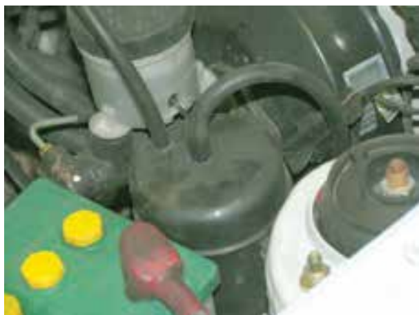
شکل ۱-۵۱ - مکان نصب مخزن کنیستر
