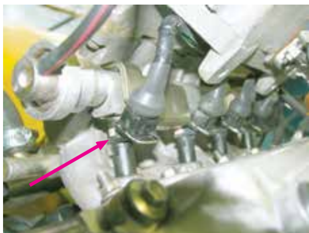
شکل ۴۱-۱- مکان نصب انژکتورها
