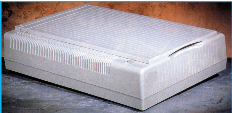
شکل ۷-۵ – با استفاده از دستگاه «پویشگر» تصاویر را می‌توان به درون رایانه جهت استفاده و ویرایش وارد کرد.
