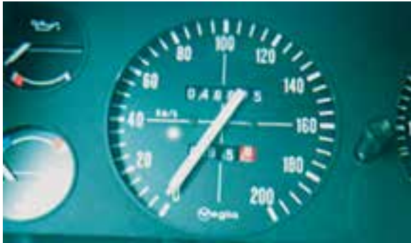
سرعت‌سنج اتومبیل سرعت آن را در هر لحظه نشان می‌دهد.
