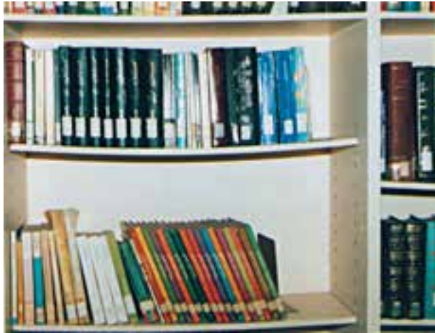
خمیده شدن تکیه‌گاه بر اثر سنگینی کتاب‌ها
