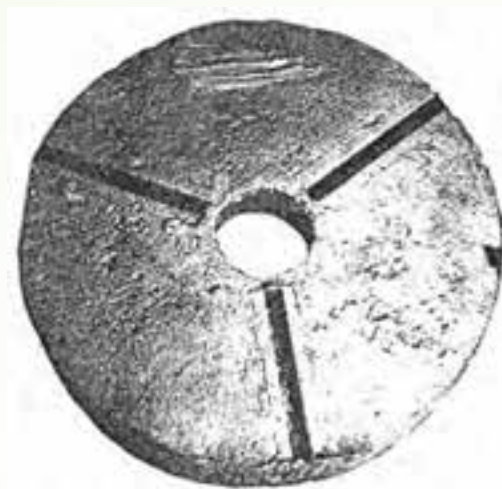
شکل ۲-۷- نمونه از قطعه با عیوب آخال و مک‌های میکروسکوپی
