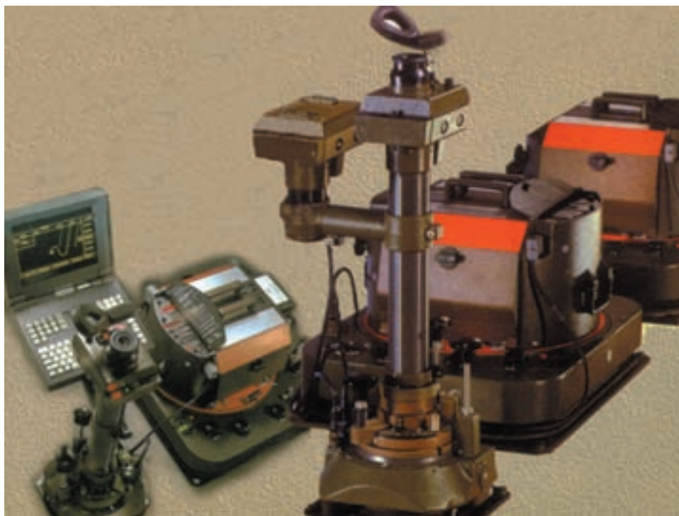
شکل ۱-۲ الف - دوربین Wild RC30 قدیمی عکس‌برداری هوایی
