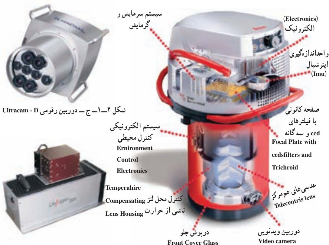
شکل ۱-۲-۱ د - سیستم LIDAR و INS جهت برداشت مستقیم توپوگرافی سطح زمین
