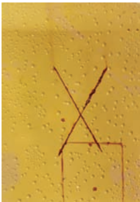
شکل ۱-۶- تاول‌زدگی (عدم مقاومت فیلم در محیط رطوبتی)
