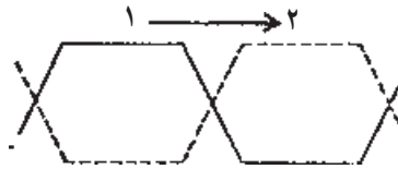
شکل ۴-۸ - تشکیل دو دهنه‌ی متوالی در ماشین بافندگی
