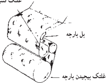
شکل ۴-۲۰- پل پارچه، غلتک کشیدن پارچه و غلتک پیچیدن پارچه
