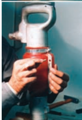
شکل ۲۸-۳- نحوه‌ی جا زدن محافظ
