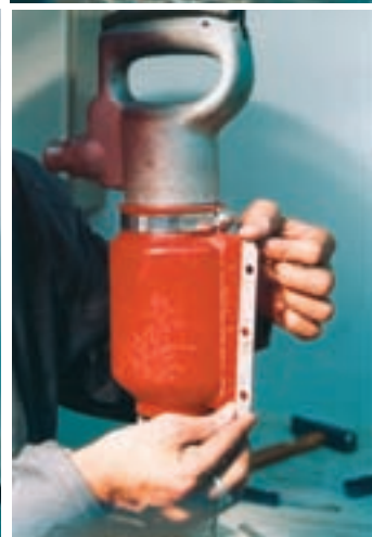
شکل ۲۸-۳- نحوه‌ی جا زدن محافظ
