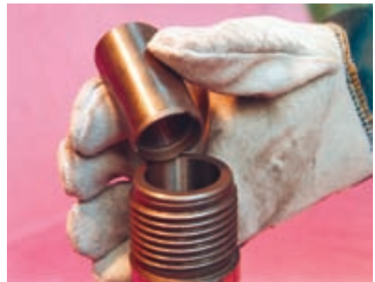
شکل ۱۶-۳- نحوه ی جازدن بوشن قلم گیر پیکور
