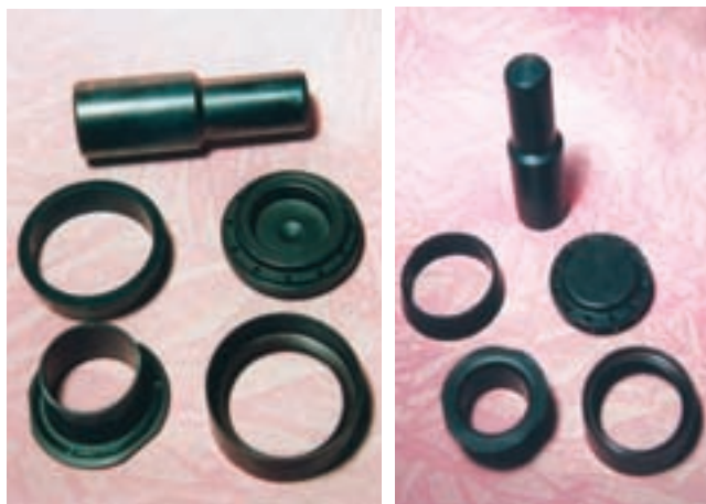
شکل ۱۵-۳- متعلقات و اجزای سیلندر پیکور
