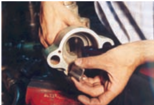
شکل ۱۶-۴- نحوه‌ی جازدن پاول و فنر و ساچمه
