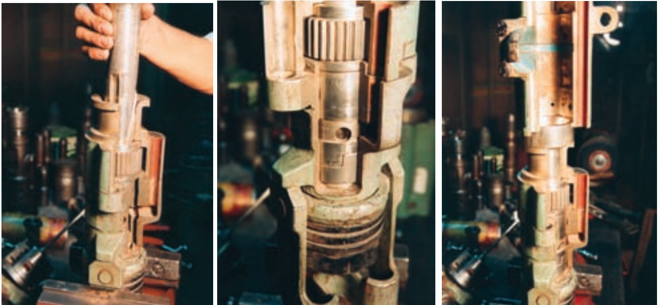
شکل ۱۸-۴- نحوه‌ی جازدن پیستون و پوسته آن
