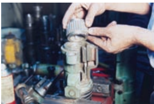
شکل ۱۷-۴- نحوه‌ی جازدن جفجغه
