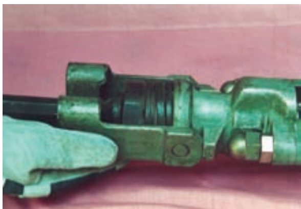
شکل ۲۵-۴- نحوه‌ی تعویض و جازدن مته
