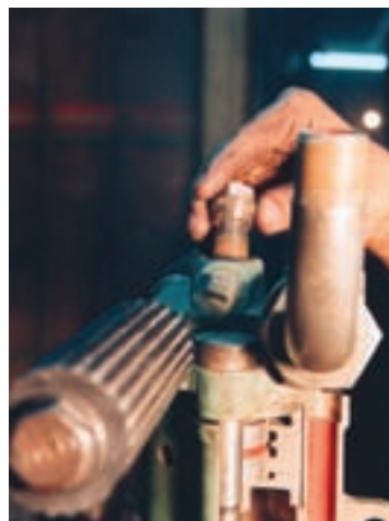
شکل ۲۳-۴- نحوه‌ی جازدن پوشش آب‌بندی و واشر آب‌بندی
