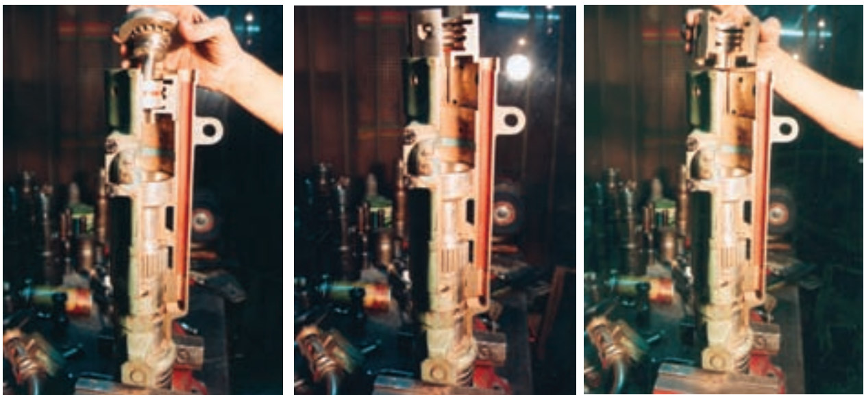
شکل ۱۹-۴- نحوه‌ی جازدن پوسته سوپاپ و سوپاپ و درب سوپاپ
