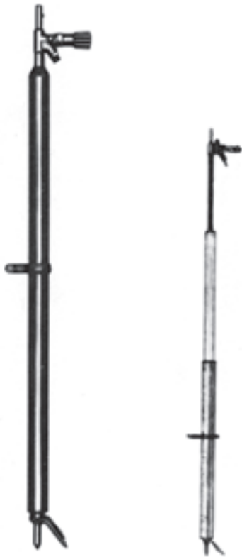
شکل ۲-۷- انواع پایه‌ی انفرادی پنوماتیکی و نحوه‌ی کارکرد با آن
