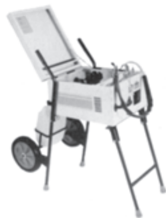
شکل ۷-۱۳- دستگاه‌های تیزکن سرمته
