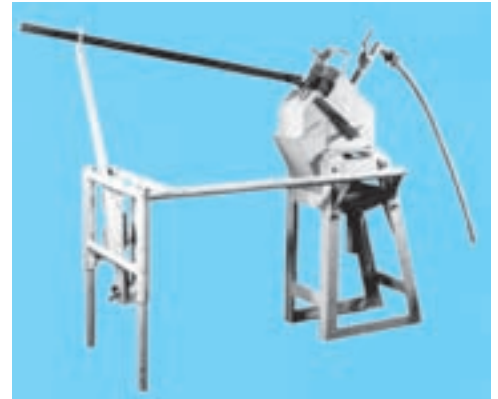
شکل ۸-۱۳- نحوه تیز کردن دکمه‌های سر مته
