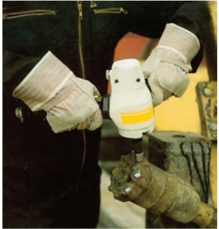
شکل ۸-۱۳- نحوه تیز کردن دکمه‌های سر مته
