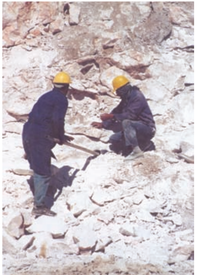
شکل ۳-۱۶- مراحل کار با سنبه چوبی
