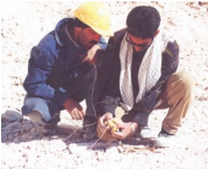
شکل ۱۲-۱۶- نحوه‌ی کارکردن با اهم متر
