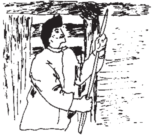
شکل ۳-۱۷- بازرسی سقف و داربست از طریق صدا
