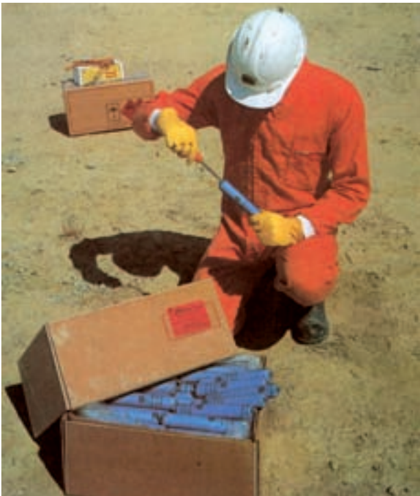
شکل ۹-۱۶- نحوه سوراخ نمودن دینامیت با درفش
