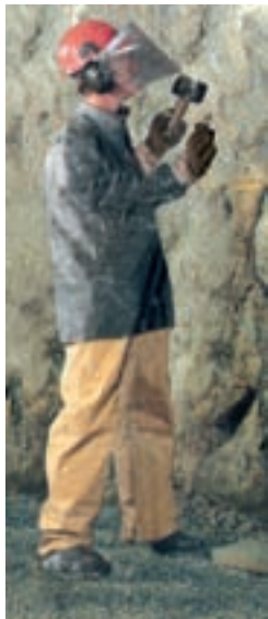
شکل ۵-۱۷- بازرسی سقف از طریق لرزش
