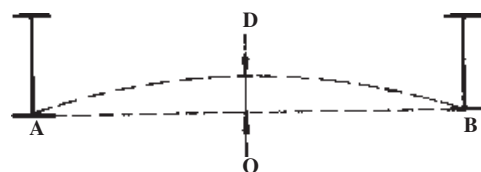
شکل ۳۵-۱۹ - نحوه‌ی تعیین خیز لازم طاق
