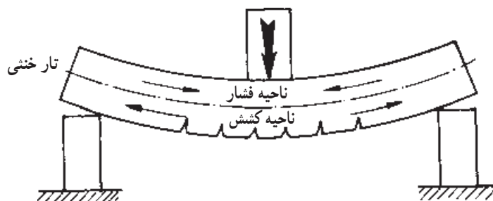
شکل ۶-۲۱- تیر بتنی پس از بارگذاری
