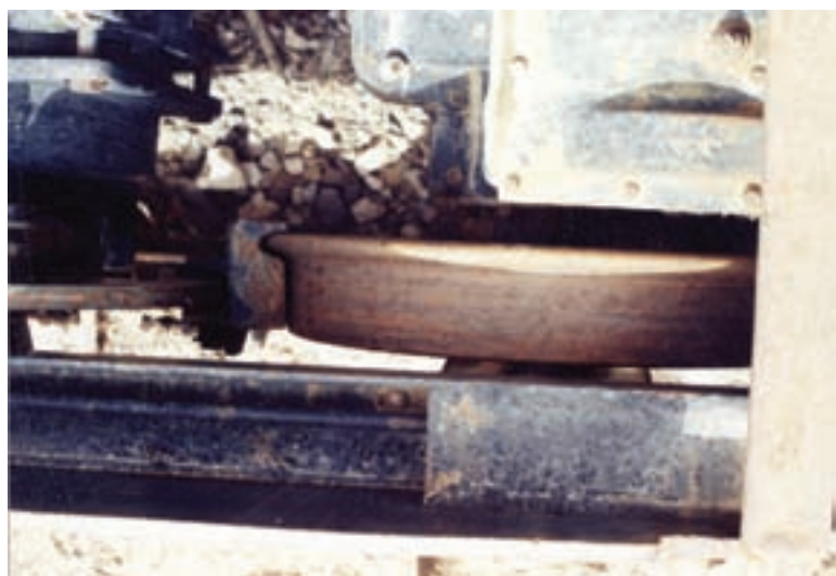
شکل ۳-۳۲- نحوه‌ی عملکرد کفشک‌های ترمز بر روی چرخ
