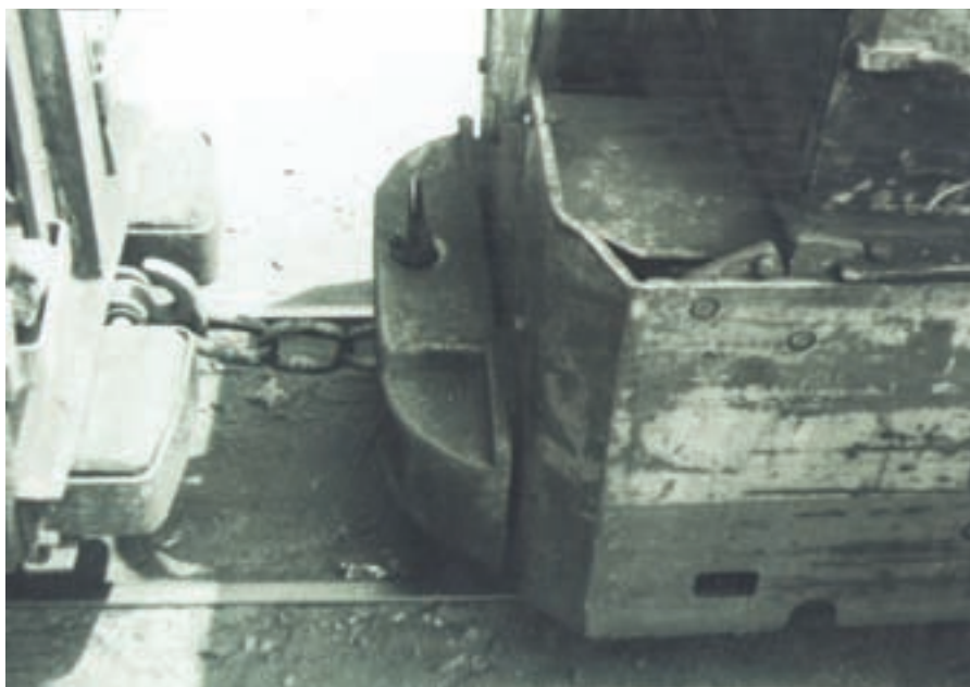
شکل ۱۶-۳۲- زنجیر و قلاب اتصال لوکوموتیو و واگن
