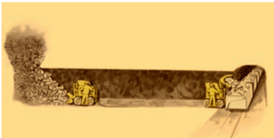
شکل ۶-۳- مراحل کارکرد لودر تونلی (خاک بر سر)
