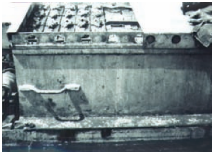
شکل ۱۰-۳۲- جعبه‌ی باتری و باتری‌های آن که به طور سری متصل شده‌اند.
