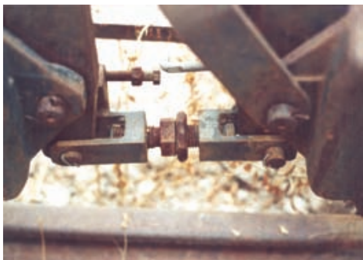
شکل ۲-۳۲- نحوه‌ی عملکرد ترمز لوکوموتیو
