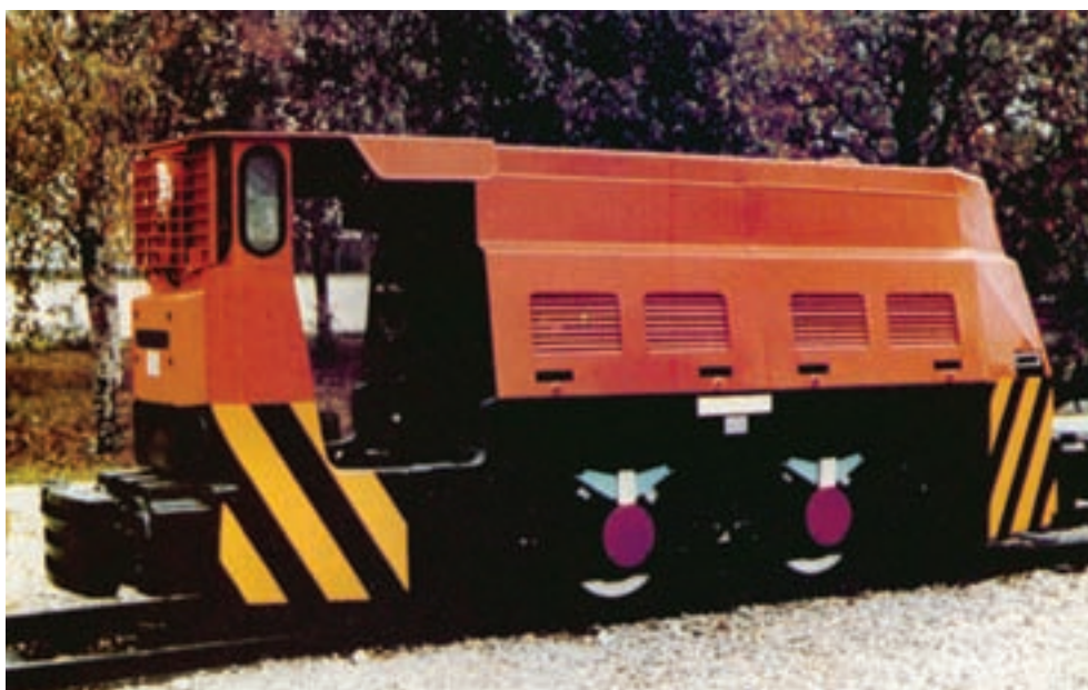
شکل ۸-۳۲- سپر ثابت فولادی و فنردار یا لاستیکی
