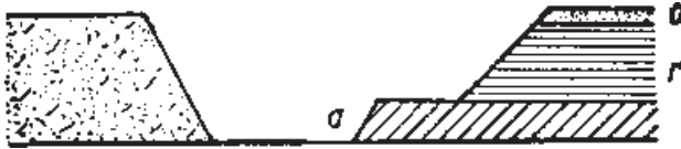
شکل ۵-۲- یک لایه افقی که نسبت باطله برداری در آن تقریباً ثابت است.
