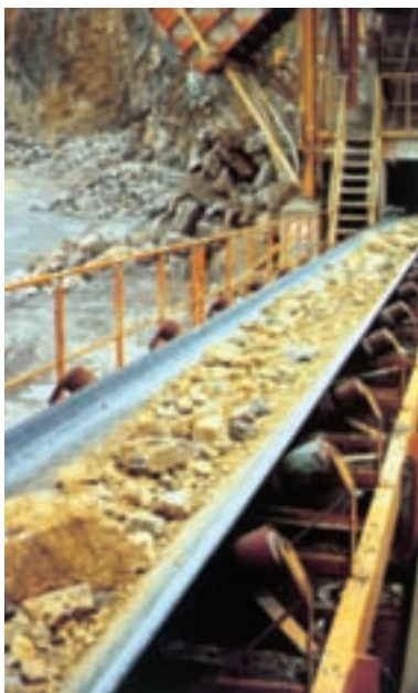
شکل ۱۷-۱- نوار نقاله در حال انتقال مواد معدنی
