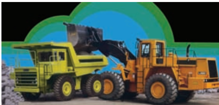
شکل ۲۴-۲- لودر در حال بارگیری
