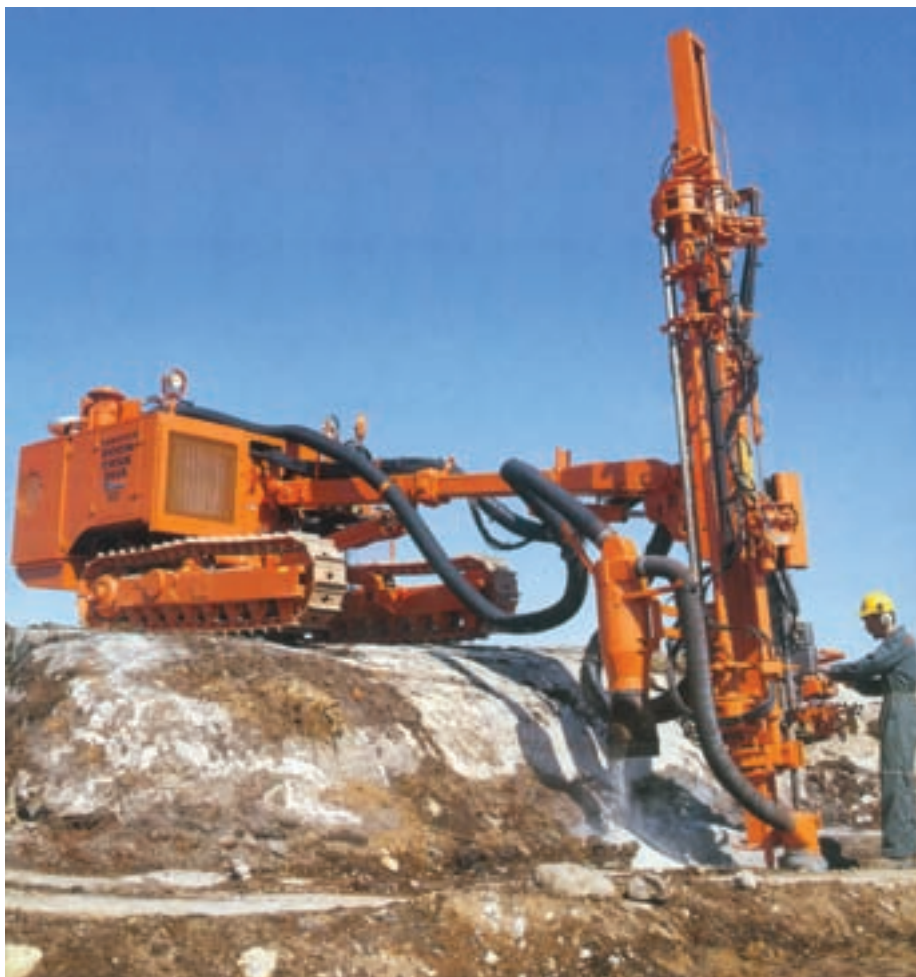
شکل ۲-۲۳- واگن دریل در حال چال زدن
