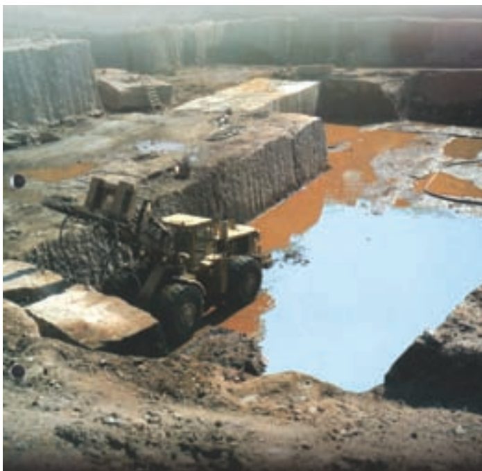
شکل ۲۶-۵- تجمع آب در معدن روباز
