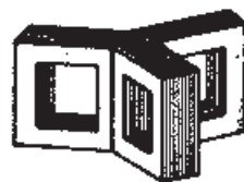
الف - سه هسته‌ی ترانسفورماتور یک فاز در کنار هم
