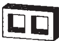
ج - شکل معمول هسته‌ی ترانسفورماتورهای سه فاز
