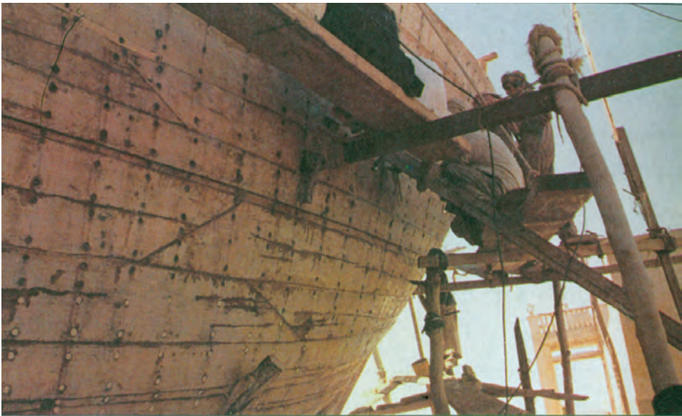
شکل ۱۶-۲ - درزگیری روکوب ردیف‌های بالای بدنه‌ی شناور با نخ‌های آغشته به روغن وال
