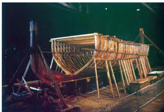
شکل ۱۵-۲- داربست اطراف اسکلت شناور برای تکمیل عملیات ساخت
