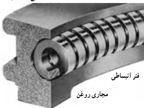
شکل ۲-۴۴- شکل قرار گرفتن رینگ‌ها در پیستون
