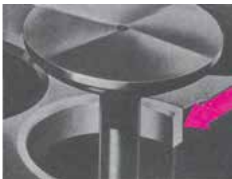
شکل ۲-۱۹- سیت سوپاپ اغلب از مواد سخت ساخته می‌شود و به طور پرسی نصب می‌گردد.
