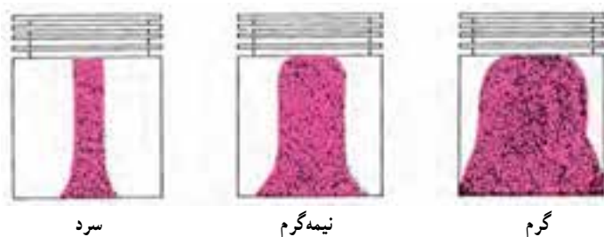
شکل ۳۴-۲- سطوح تماس پیستون بیضی شکل از حالت سرد بودن تا گرم شدن کامل
