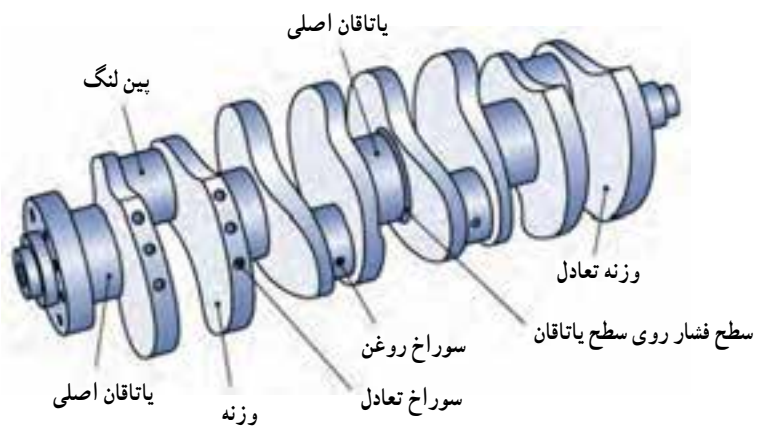
شکل ۶۵-۲- فرم میل لنگ و اجزای آن
