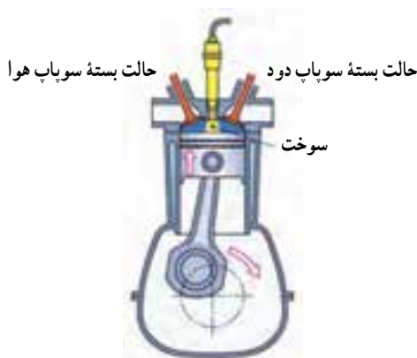
شکل ۳-۵- کورس تراکم، هر دو سوپاپ بسته هستند.
