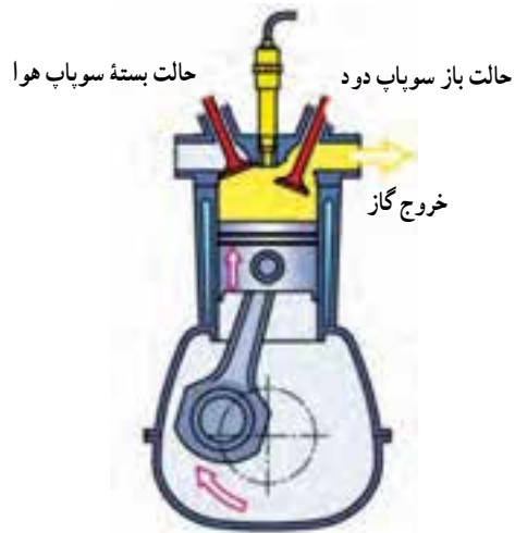
شکل ۵-۶- کورس تخلیه، سوپاپ دود باز و سوپاپ گاز بسته است.
