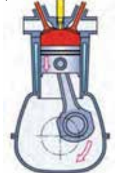
شکل ۴-۵- کورس قدرت، هر دو سوپاپ بسته هستند.
