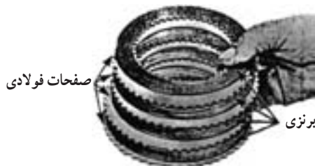
شکل ۱-۱۷- کلاچ چند صفحه‌ای در جعبه دنده اتوماتیک
