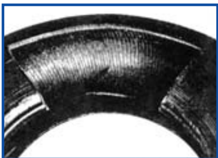
شکل ۳۱-۵ پارگی دیواره تایر در اثر اصابت به جسم لبه تیز
