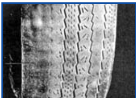
شکل ۵-۲۳- ساییدگی در اثر کمبر غلط
