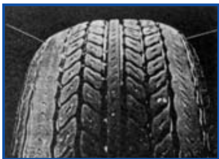
شکل ۵-۲۱- سایش دو طرف در اثر پیچیدن تند
