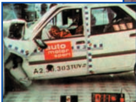
شکل ۱۱-۲- آزمایش ضربه روی سواری سیترون ZX
