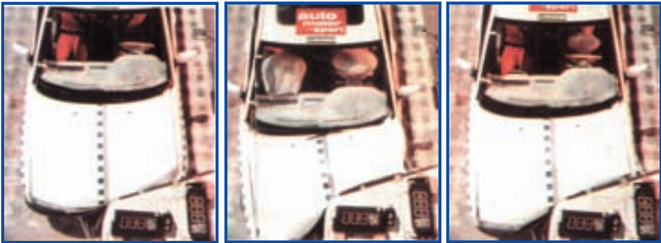
شکل ۱۲-۲- نحوه برخورد خودرو به مانع سیمانی ۱۵ درجه
