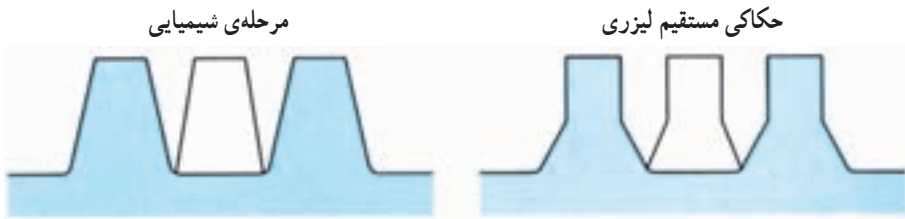
شکل ۳-۳- مقایسه‌ی ایجاد نقش برجسته‌ی یک پلیت چاپ فتوپلیمر تولید شده در یک مرحله‌ی فتوگرافیک / شیمیایی با پلیت (لاستیکی) حکاکی شده توسط لیزر
