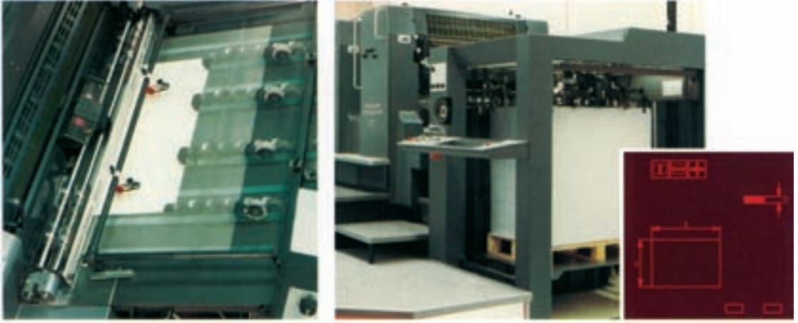
شکل ۱۳-۶- پیش تنظیمات اتوماتیک واحد تغذیه
