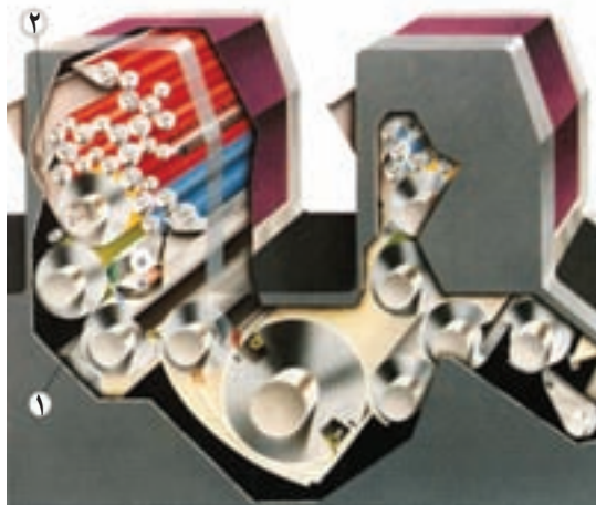
شکل ۲-۶- سیستم‌های شست‌وشوی اتوماتیک. ۱- سیلندرها ۲- نوردها
