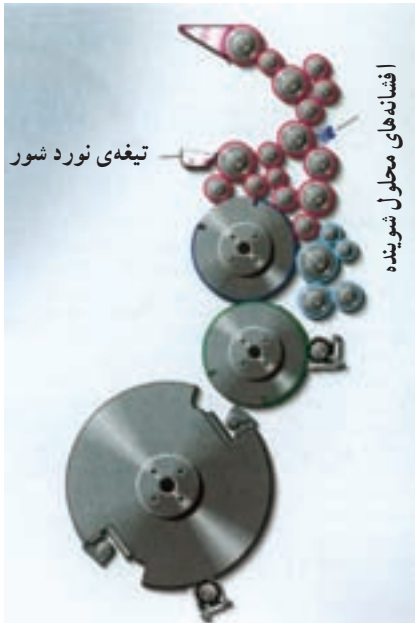
شکل ۶-۷ سیستم شست‌وشوی اتوماتیک نوردهای مرکب
