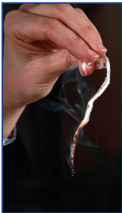
شکل ۱۵-۳ سوختن الیاف ابریشم
