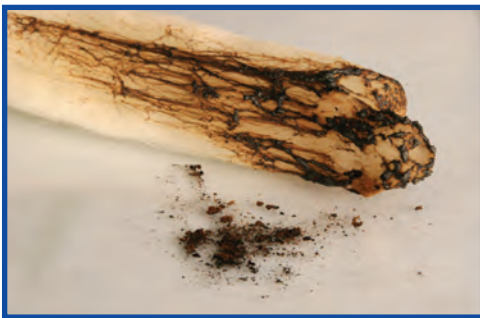
شکل ۳-۷ خاکستر حاصل از سوختن الیاف پشم
