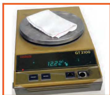
شکل ۱-۱- تعیین وزن پارچه با استفاده از ترازو
