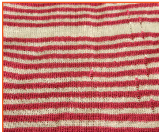
شکل ۹-۹- در رفتن حلقه‌ها و ایجاد سوراخ در پارچه حلقوی پودی
