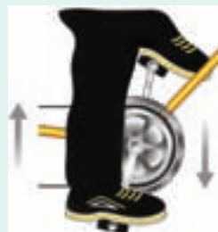
با فشردن رکاب گشتاوری ایجاد می‌شود که چرخ‌دنده‌ها و زنجیر را می‌چرخاند.
