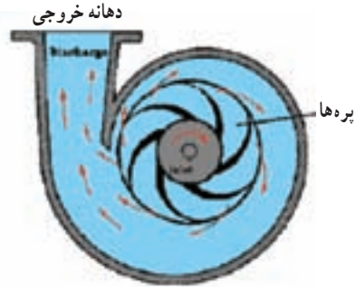
شکل ۲-۵- پوسته حلزونی پمپ افقی
