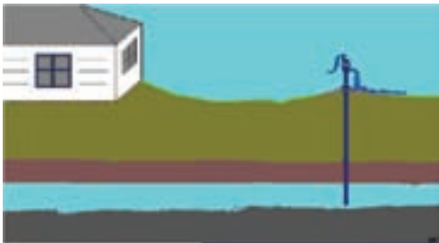
شکل ۸-۱- پمپ آب دستی
