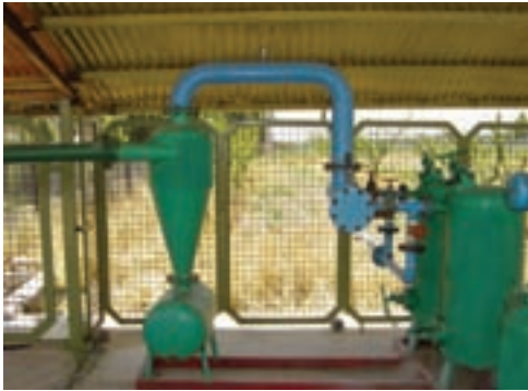
شکل ۲۷-۶- نحوه کار سیکلون و شکل ظاهری آن
