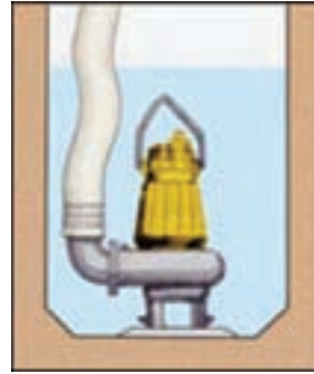
شکل ۸-۵- نصب پمپ کف کش در چاهک
