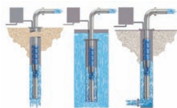
شکل ۵-۵- حالات مختلف نصب پمپ شناور
