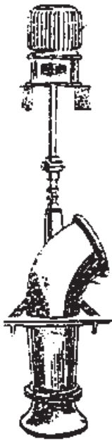
شکل ۱۶-۵- پمپ جریان محوری که توسط موتور الکتریکی به حرکت در می‌آید.
