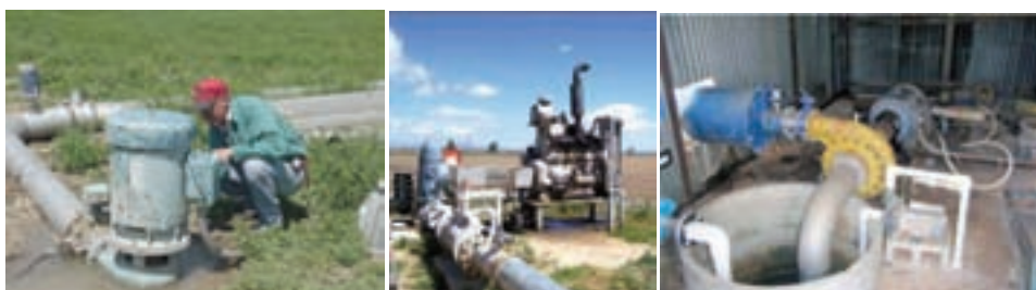
الف) پمپ با موتور الکتریکی سرچاهی (ب) پمپ با موتور احتراقی (ج) پمپ شافت و غلافی با موتور الکتریکی
