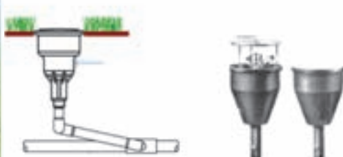
الف) ساختار آب پاش مخفی شونده ب) چگونگی نصب آب پاش
