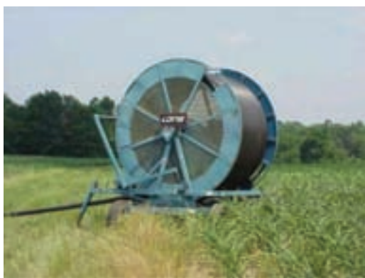
شکل ۶۲-۷- ماشین آبیاری قرقه‌ای مستقر شده در مزرعه با لوله باز شده
