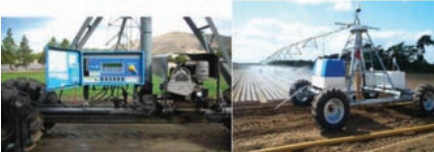
ب) استفاده از کابل برق در دستگاه لیشیر
