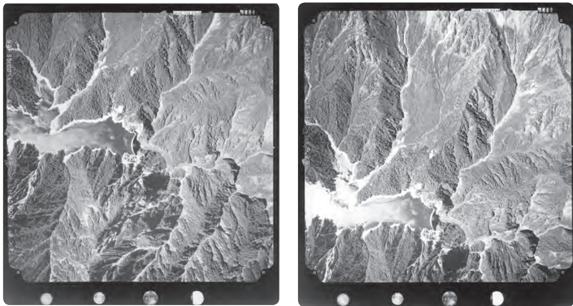
شکل ۹-۱- زوج تصویر عکسبرداری شده از یک منطقه
