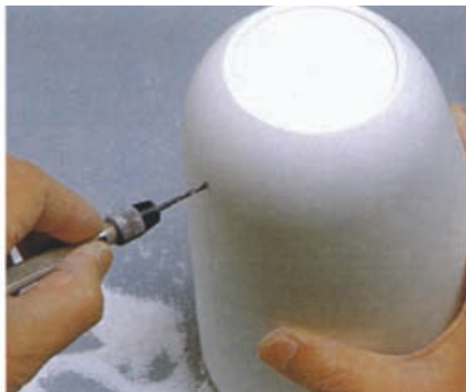
۲۰- ایجاد سوراخ و بین گذاری برای اتصال قطعه الحاقی (مرحله چهارم - مونتاژ)
