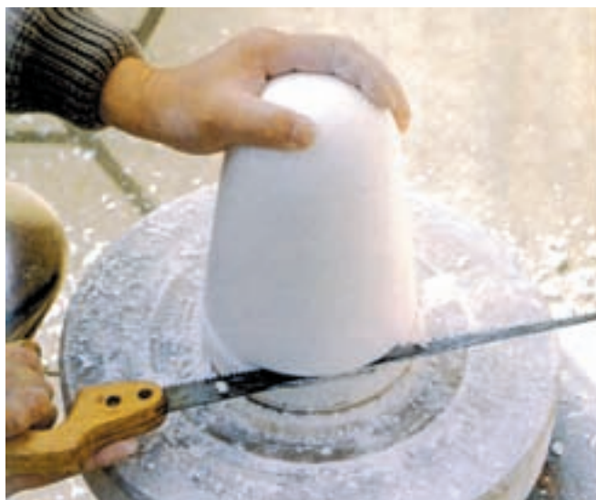
۵- مدل از روی چرخ، جدا می‌شود. و به این ترتیب مرحله اول به پایان می‌رسد.
