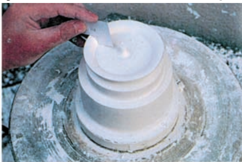
۱۵- ایجاد انحنای میزان انحنای لبه کار با شابلون بررسی می شود.
