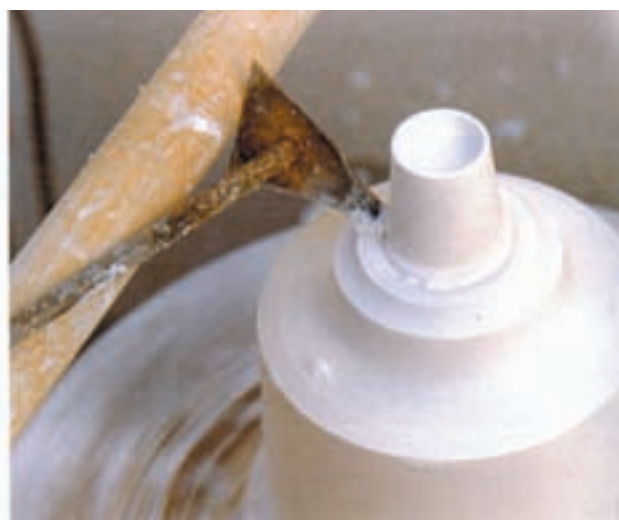
۹- مشخص کردن ارتفاع دقیق
