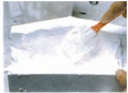
۱۶- گچ را درون قالب یک دست کنید.
