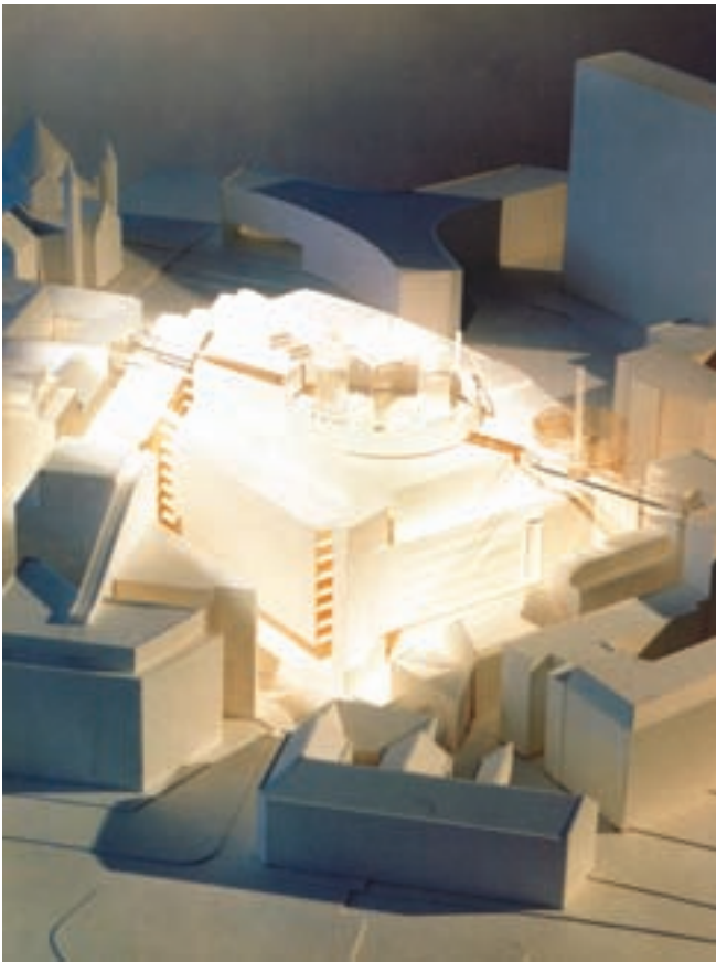
شکل ۳۹- تصویر ماکتهای اتود و گذرا را در حاشیه تصویر اصلی برای تفهیم می‌توان دید و همچنین اتود و «کلیت» بودن در ماکت فضای شهری از سادگی عناصر تشکیل‌دهنده آن مشهود است - ساخته شده از مقوای ماکت - استایروفوم - بلوفوم - یلوفوم و مواد دیگر برای عناصر ریز آن.
