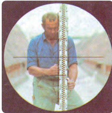
شکل ۱۴-۸- طریقه‌ی نگاه داشتن میر
