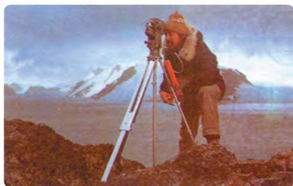
ج- سانتراژ با شاقول میله‌ای در یک کار ژئودزی
