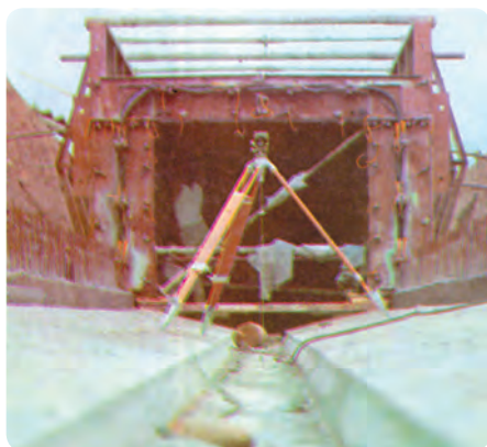
شکل ۳۰-۸- دوربین تراز یاب، سانتراژ با شاقول
