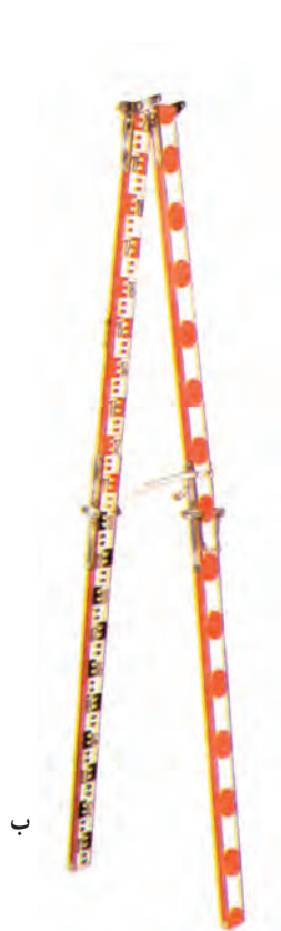
شکل ۸-۱۳- میر معمولی تراز یابی
