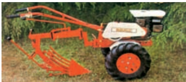
شکل ۲-۶۹- گاو آهن دو طرفه
