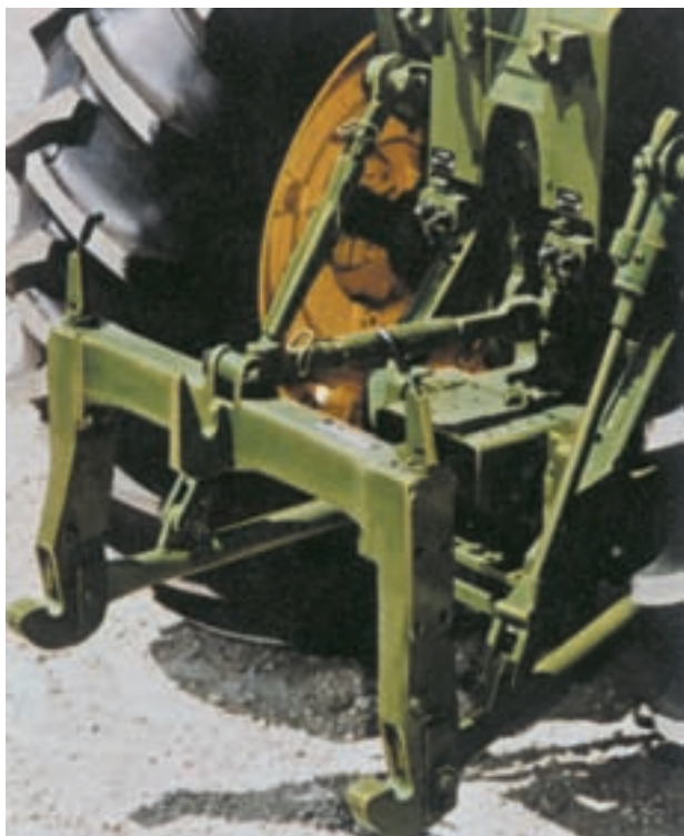
شکل ۲-۶۵- مالبند اتصال سریع
