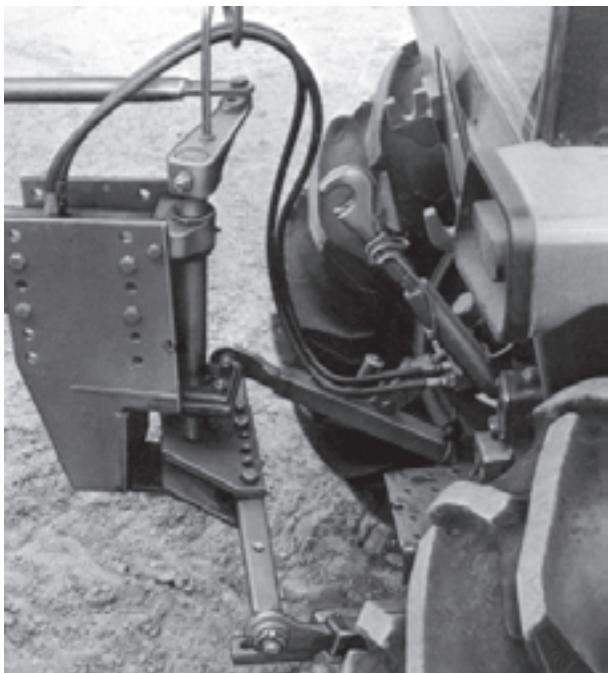
شکل ۲-۷۵- برقراری اتصال بازوها و اتصال هیدرولیکی
