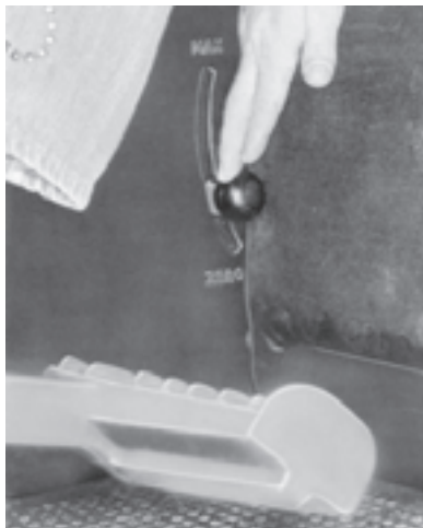
الف - اهرم انتخاب وضعیت در تراکتور M ۶۵۰ U ب - اهرم انتخاب وضعیت در تراکتور جاندر
