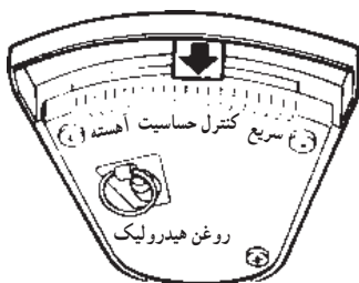
شکل ۱۲-۳- اهرم کنترل حساسیت در تراکتور
