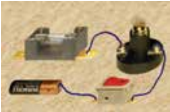
شکل ۴-۴۱ - سیم متصل به باتری و کلید قطع شده و لامپ به حالت خاموش درآمده است.
