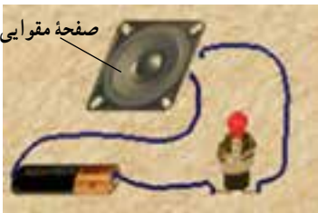
شکل ۴۸-۴- مدار آزمایش بلندگو در نرم افزار ادیسون
