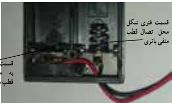
شکل ۱-۵- محل اتصال قطب‌های مثبت و منفی باتری در جای باتری
