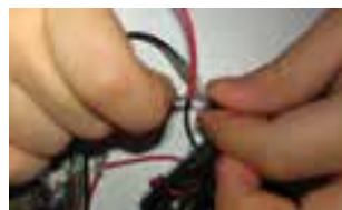
شکل ۳-۱۱- برقراری اتصال سیم رابط با پایه مثبت آی‌سی
