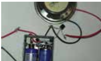
شکل ۳-۸ اتصال سیم مثبت بلندگو به آی سی
