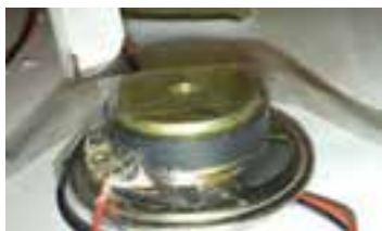
ب- روی بلندگو نوارچسب شفاف بچسبانید به طوری که از دو طرف آن بیرون بیاید.
