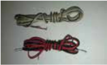
شکل ۱-۲ نمونه‌هایی از سیم افشان با قطر ۰/۵ یا ۰/۵ میلی‌متر
