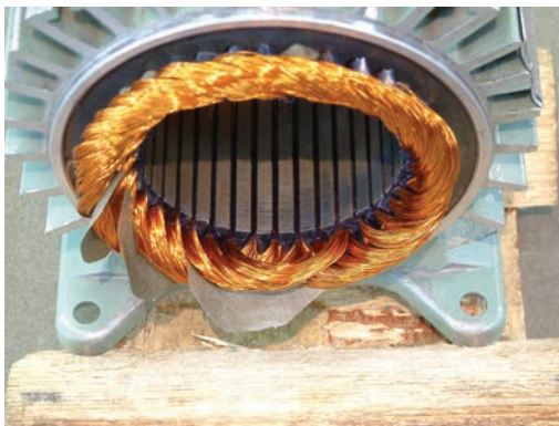
شکل ۲-۳۱- عایق کاری پیشانی کلافها
