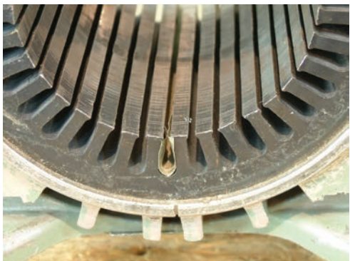
شکل ۲-۳۳- اندازه گیری محیط شیار
