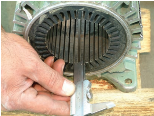
شکل ۲۶-۲- اندازه گیری محیط داخلی و طول شیار
