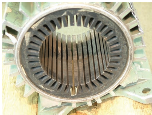
شکل ۲-۳۶- آزمایش عایق در داخل شیار
