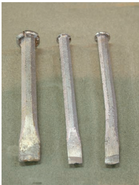
شکل ۲-۱۹- چند نمونه قلم برای بریدن سیم‌ها
