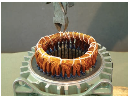
شکل ۱۳-۲ – چیدن نخ‌های کلاف بندی با سیم چین
