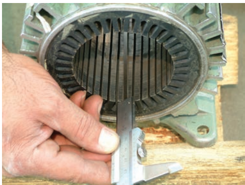
شکل ۲-۳۲- اندازه گیری طول شیار
