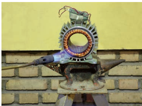
شکل ۲-۱۸- سوزاندن مستقیم سیم‌ها با شعله
