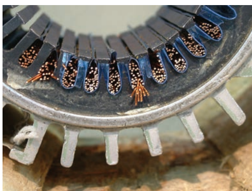
شکل ۲-۲۱ - برش سیم‌ها در یک طرف استاتور
