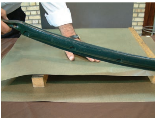
۲۹-۲- کاتر یا دستگاه برش‌دهنده‌ی عایق‌های برشمان
