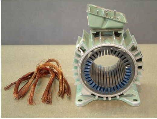
شکل ۲-۲۴- سیم‌های بیرون آمده از استاتور
