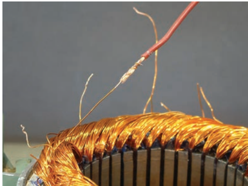
شکل ۴-۱۱- اتصال سیم‌های افشان به سیم‌های لاک‌ی
