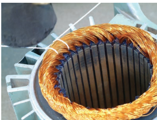
شکل ۴-۱۶- کشیدن نخ و زدن ضربه‌ی ملایم روی آن
