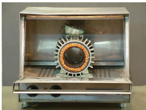
شکل ۲۰-۴ گرم کردن استاتور
