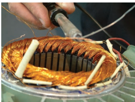
شکل ۷-۴- لحیم کاری محل اتصال سیم ها
