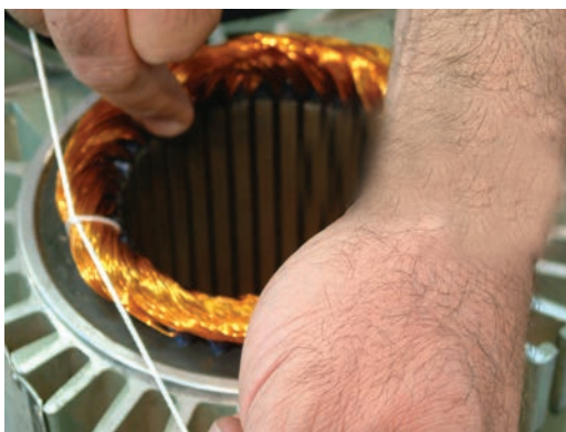
شکل ۴-۱۴- گره زدن یک سر نخ
