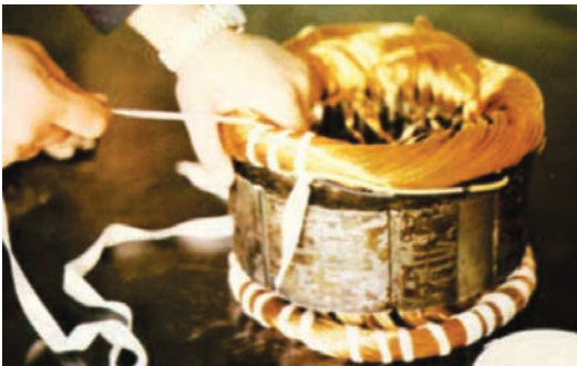
شکل ۴-۱۸– نواربندی سیم‌های استاتور
