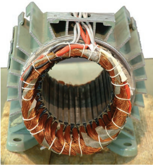
شکل ۴-۱۷– نمایش استاتور نخ‌بندی شده از دو سمت
