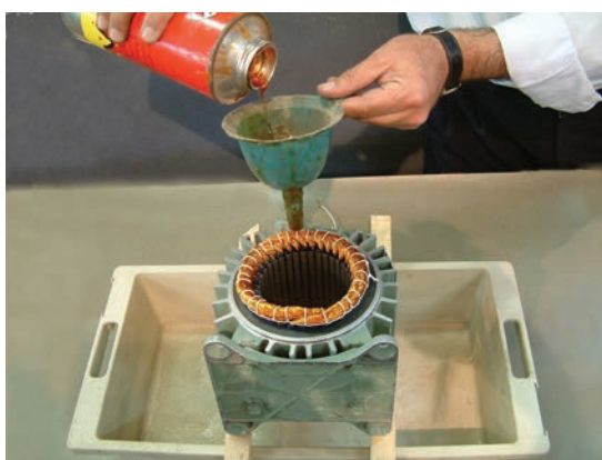
شکل ۴-۲۵- ریختن شارلاک روی سیم‌ها
