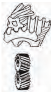
درگیری دو چرخ‌دنده مارپیچی
