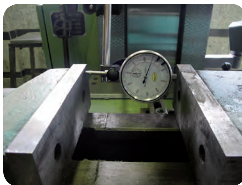
کنترل گونیا بودن فک‌های گیره نسبت به میز دستگاه
