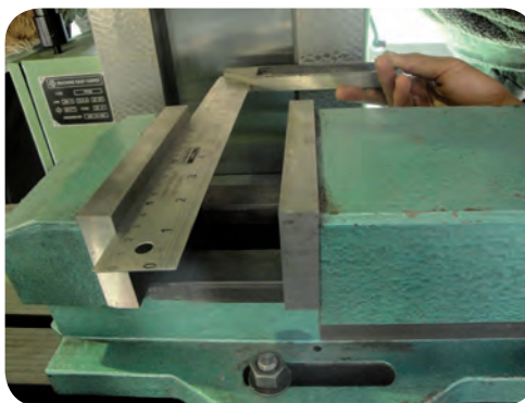
تنظیم فک‌های گیره با استفاده از گونیا
