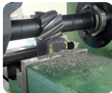
کف تراشی با تیغه فرز غلطکی و با استفاده از ماشین فرز افقی
