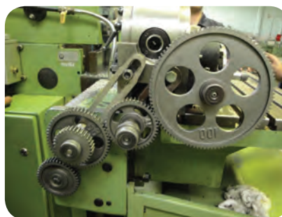
نحوه انتقال حرکت بین میز و دستگاه تقسیم
