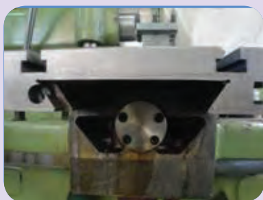
کاربرد شیاردم چلچله ای در سوپرت دستگاه
