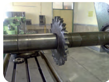
نصب تیغه فرز شیار تراش بر روی ماشین فرز افقی
