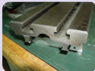
نمونه شیارهای T شکل
