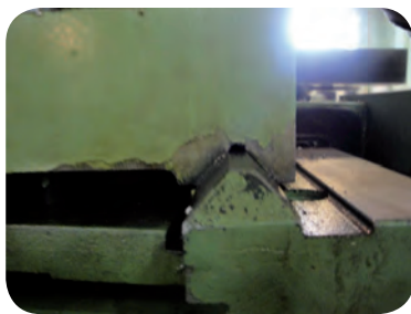
نمونه شیار V شکل
