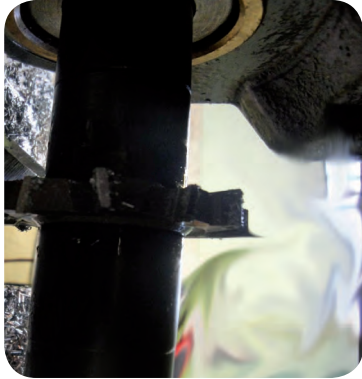
ایجاد شیارهای V شکل ۹۰ درجه با تیغه فرز پولکی
