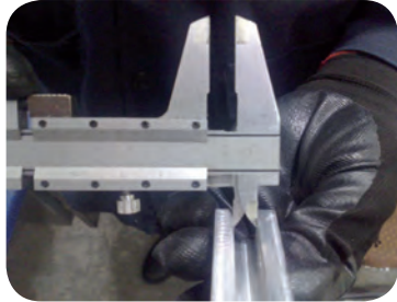
اندازه گیری پهناي شیارها با کولیس ورنیه دار
