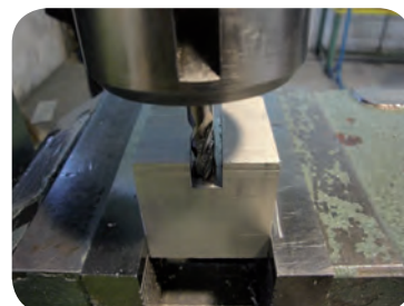
شیار تراشی با تیغه فرز انگشتی
