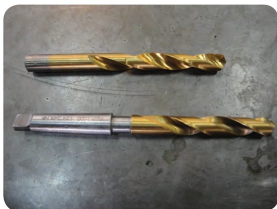
دنباله استوانه‌ای و مخروطی در مته‌ها
