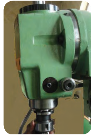
تصویری از محور استوانه‌ای دستگاه و پیچ تثبیت آن
