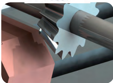
استفاده از تیغه فرزهای زاویه دار برای ایجاد سطح شیب‌دار با ماشین فرز افقی
