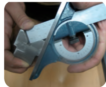
کنترل شیب قطعه با زاویه سنج انیورسال
