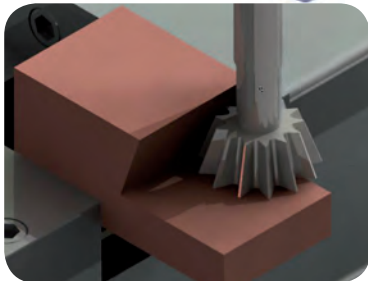
استفاده از تیغه فرزهای دم چلچله‌ای برای ایجاد سطح شیب‌دار
