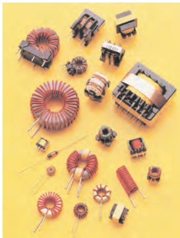
شکل ۸-۱۲ چند نمونه سلف کوچک
