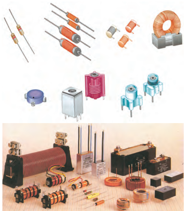
شکل ۸-۳۱ چند نمونه سلف ثابت و متغیر
