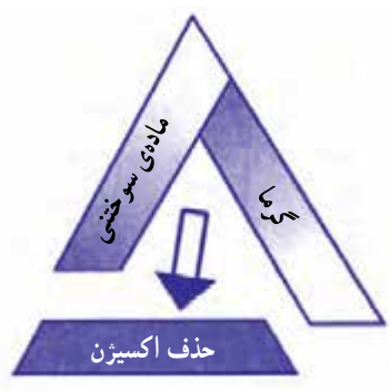
شکل ۱۶-۱- ممانعت از رسیدن اکسیژن به ماده‌ی سوختنی
