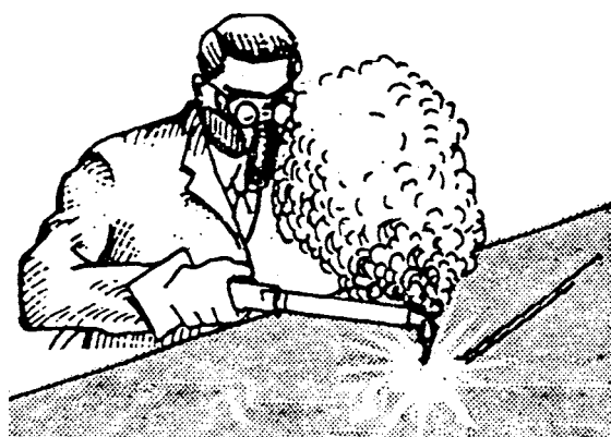
شکل ۳۰-۱- در موقع برشکاری روی سطوح گالوانیزه و رنگ شده از ماسک تنفسی استفاده کنید.
